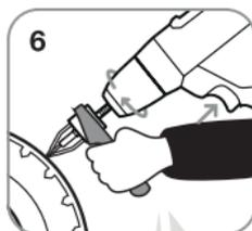
7. Удерживая устройство за ручку-упор, активировать инструмент (шурупверт или бытовую дрель), обладающий вращательным движением (не более 500 об/мин, по часовой стрелке), установить шип в отверстие. Извлекая дошипун из отверстия после установки шипа, продолжайте удерживать ручку устройства, чтобы избежать проворачивания штифтов в резине протектора и минимизировать риски их слома.
