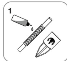
**Установка ремонтных шипов производится в отверстия, откуда вылетели или демонтированы изношенные заводские шипы.**
