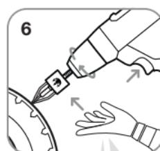
7. Придерживая устройство рукой, активировать инструмент (шуруповерт или бытовую дрель), обладающий вращательным движением (не более 500 об/мин, по часовой стрелке), установить шип в отверстие. Извлекая дошипун из отверстия после установки шипа, продолжайте придерживать корпус рукой, чтобы избежать проворачивания штифтов в резине протектора и минимизировать риски их слома.
