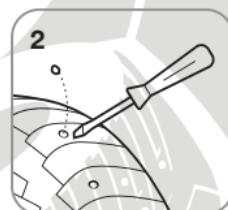
2. Замерить глубину отверстия под шип глубиномером или штангенциркулем (рис. 3).
